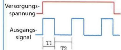
Mit Anlegen der Spannung setzt sich der Timer zurück und startet die ON-Phase für die Dauer T1, anschließend wird für die Dauer T2 die OFF-Phase geschaltet. Diese Phasen wiederholen sich bis die Spannung entfernt wird.
